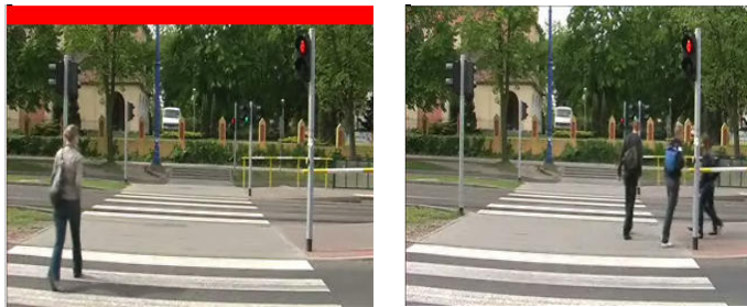
Rys. 10. Wynik analizy przejścia na czerwonym świetle [4]. Pasek na górze obrazu oznacza wykrytą niebezpieczną sytuację
