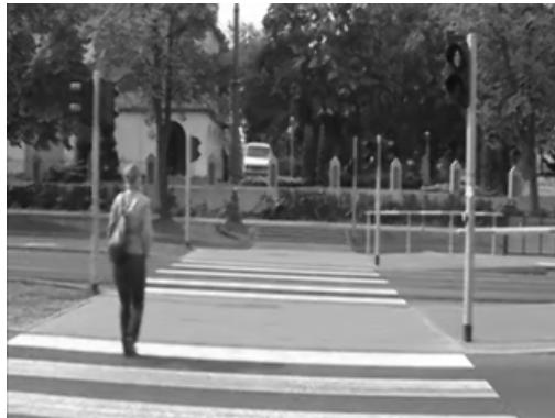
Rys. 6. Klatka 63 filmu po przekształceniu do skali szarości oraz po filtracji medianowej [4]
