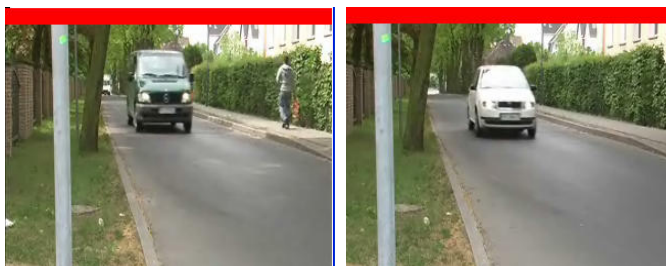
Rys. 12. Przykłady prawidłowego rozpoznania programu w analizie nieprawidłowej jazdy na ulicy jednokierunkowej [4]. Pasek na górze obrazu oznacza wykrytą niebezpieczną sytuację
