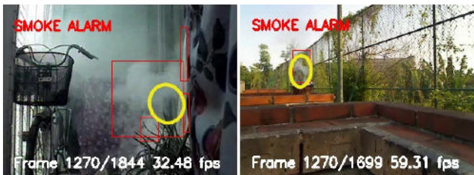
Rys. 15. Efekt działania algorytmu wykrywania dymu [19]
