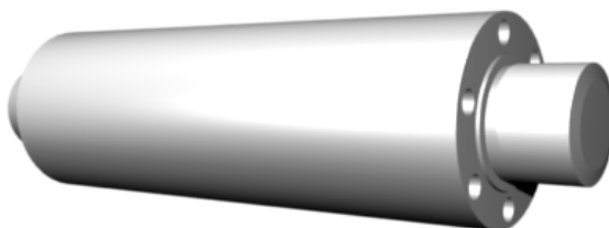
Rys. 1. Schemat wału kalandra z otworami grzejnymi i czopami łożyskowymi
