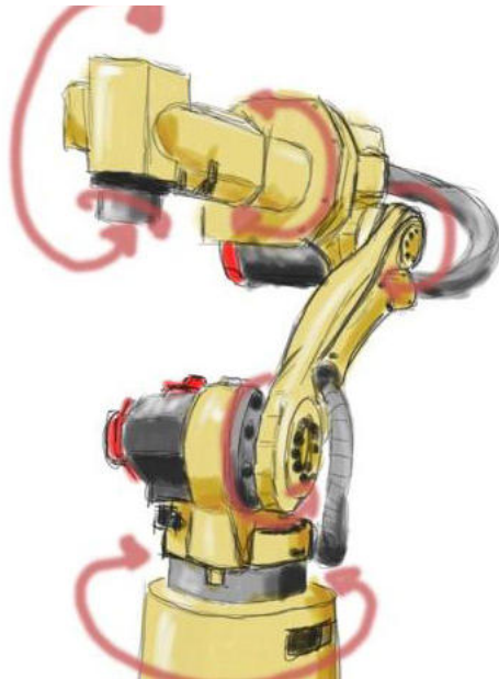
Rys. 13. Koncepcja ruchu robota 6-osiowego Fanuc M6i-B
