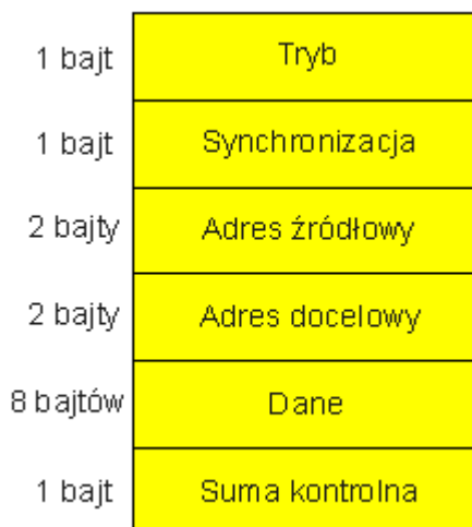
Rys. 8. Struktura danych pakietu „pagerowego”.
