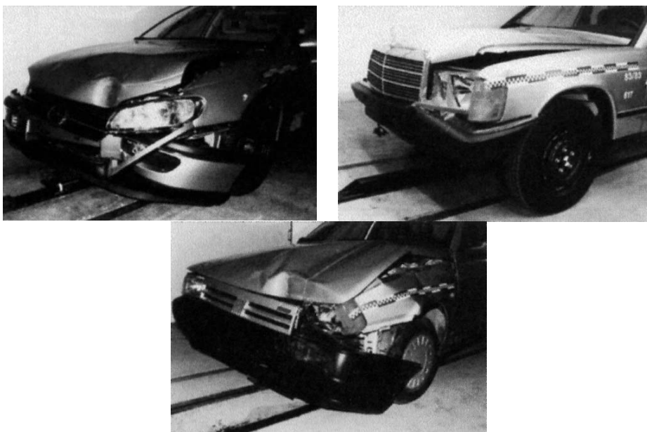
Rys. 1. Przykładowe stany deformacji przodu nadwozia dla prędkości 15 km/h
