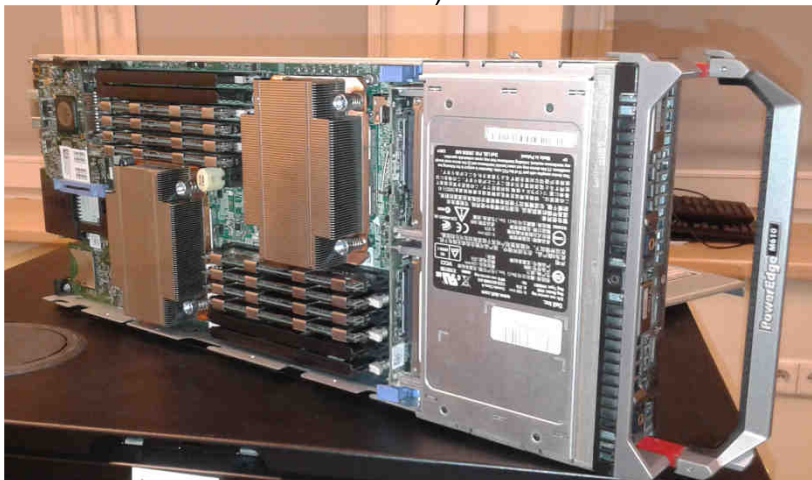
Rys. 3. Serwer kasetowy (blade) a) kaseca z wstawionymi serwerami, b) pojedynczy serwer kasetowy
