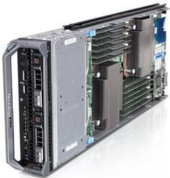
Rys. 2. Serwer kasetowy (blade) a) kasecja z wstawionymi serwerami, b) pojedynczy serwer kasetowy
