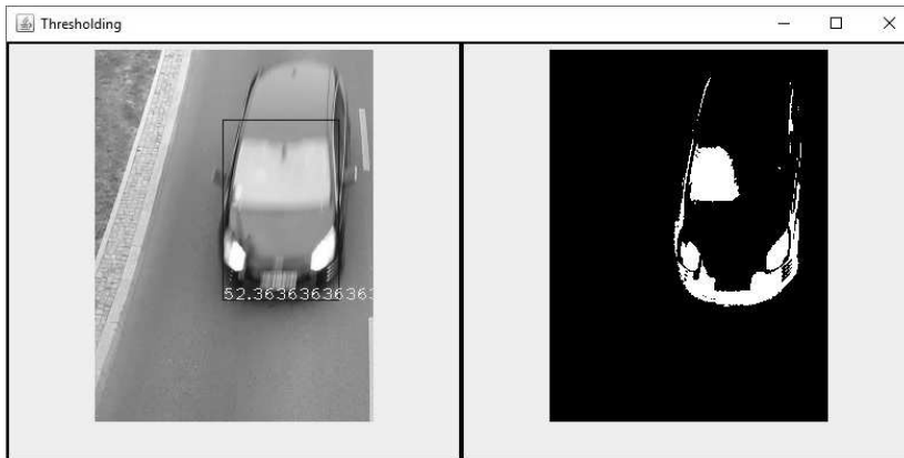
Rys. 2. Przykład działania aplikacji – obliczanie prędkości obiektu
